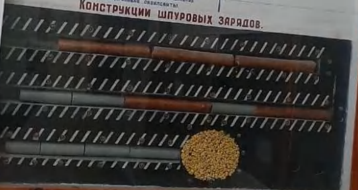
2. В зависимости от состава: Аммианослитермные, нитродринные, нитроглицеринвад, оксиделиты КОНСТРУКЦИИ ШПУРОВЫХ ЗАРЯДОВ. 1 Сплошной (удлиненный). 2 Рассредоточенный прерывной 3 Катловый (чашечный).
