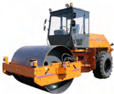
Рис.4. Грунтовый виброкаток ДУ-85
