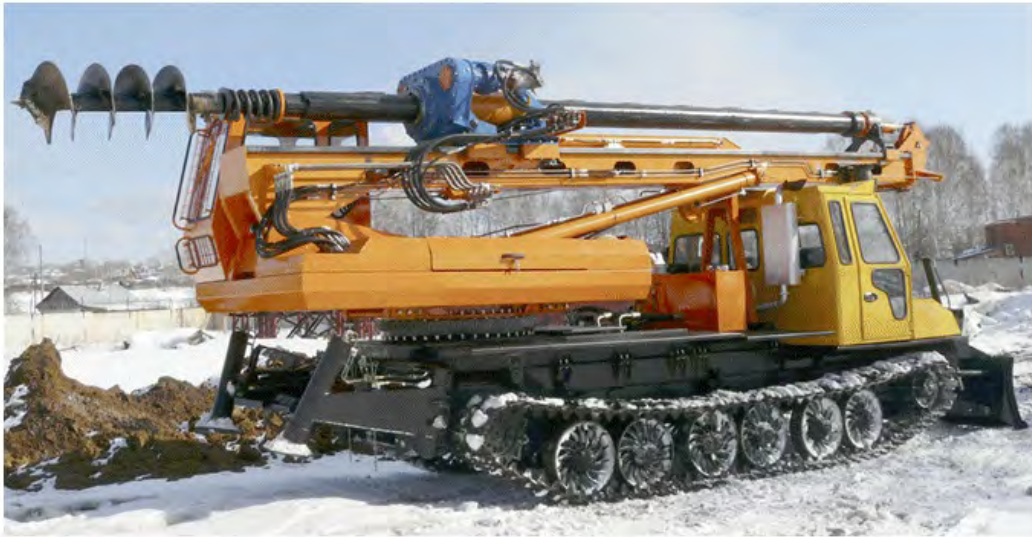
Рис.4. Бурильно-крановая машина БКМ-2032
