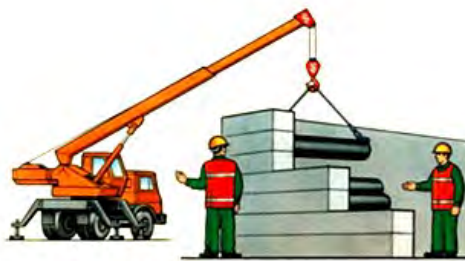
Рис.20. Передача сигналов в ограниченной зоне видимости
