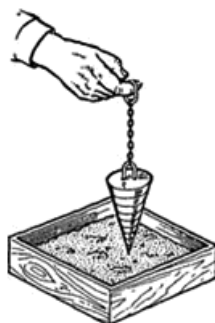
Рис. 21. Проверка подвижности раствора эталонным конусом
