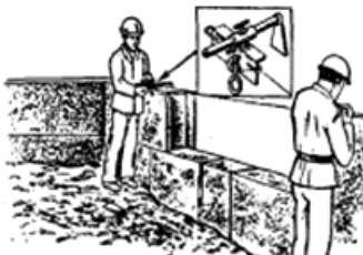
Рис.14. Установка маячных блоков и натягивание причалки
