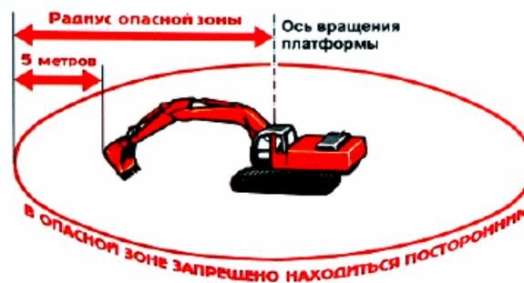
Рис.14. Граница опасных зон при работе экскаватора
