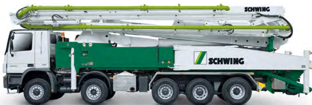
Рис.4. Автобетононасос SCHWING S 36 SX
