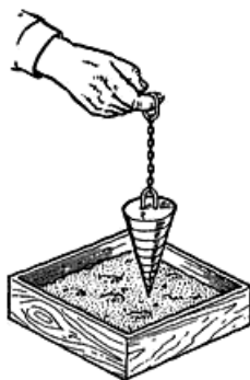
Рис.19. Проверка подвижности бетона эталонным конусом
