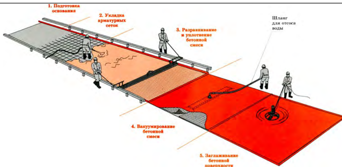
Рис.18. Технологическая последовательность бетонирования монолитной плиты
