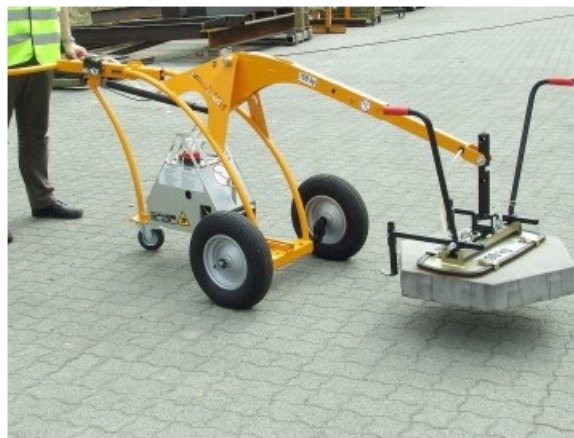
Рис.2. Устройство для укладки UNIMOBIL UM-SM
