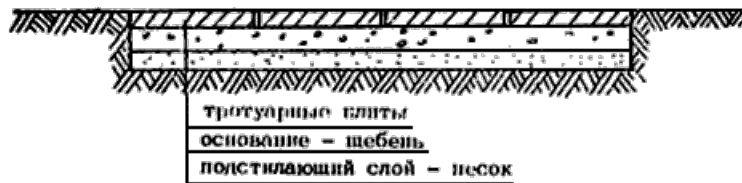
Рис.5. Конструкция тротуара с покрытием из бетонных плит
