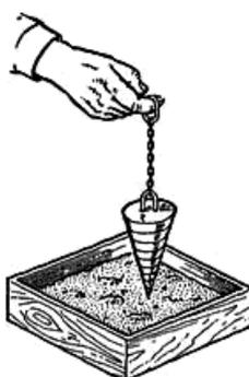
Рис. 16. Проверка подвижности раствора эталонным конусом
