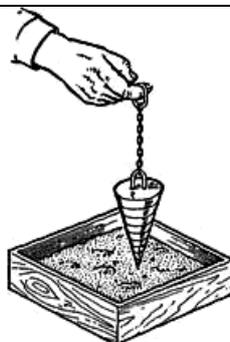
Рис. 17. Проверка подвижности бетона эталонным конусом
