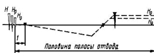
Рис.7. Схема установки кольев на обрезах с нанесением на них высотных отметок:
