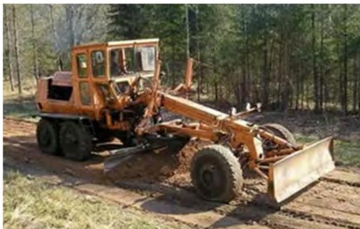
Рис.19. Работа автогрейдера на разравнивании грунта
