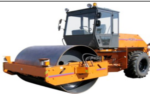
Рис.4. Грунтовый виброкаток ДУ-85
