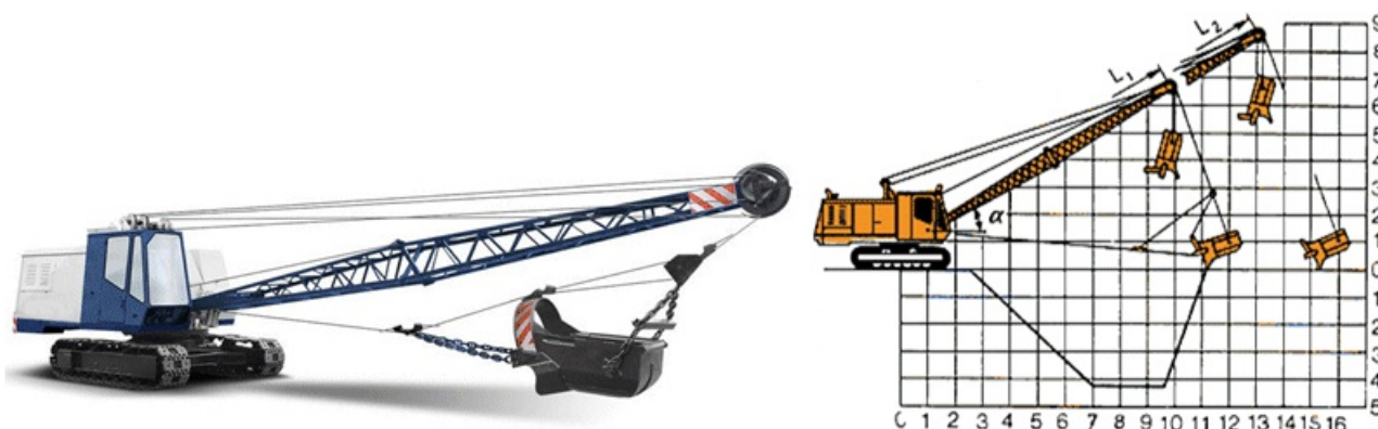
Рис.2. Грузовые характеристики экскаватора ЭО-4112-А-1 при работе драглайном
