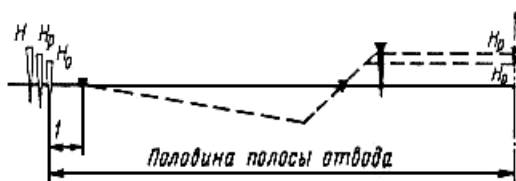
Рис.10. Схема установки кольев на обрезах с нанесением на них высотных отметок:
