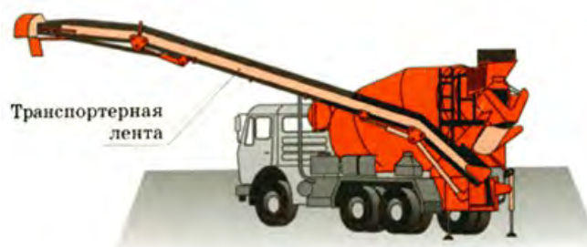
Рис.9. Подача бетонной смеси по транспортерной ленте
