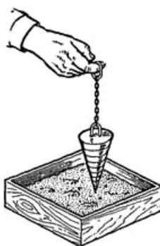
Рис. 16. Проверка подвижности бетона эталонным конусом
