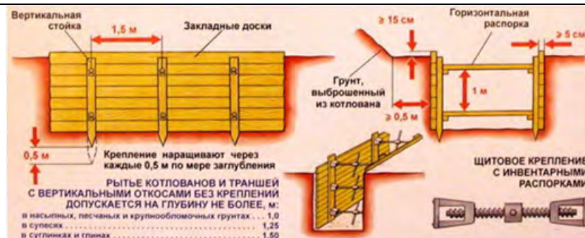
Рис. 15. Правила установки креплений
