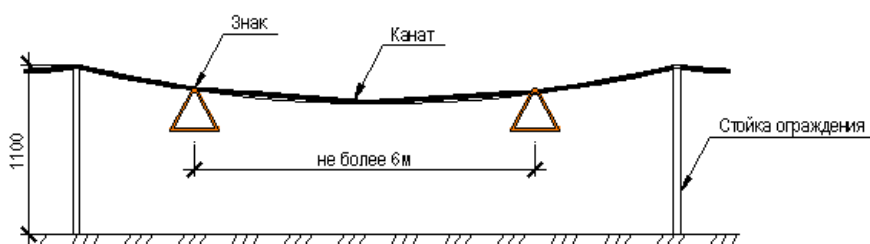
Рис.48. Конструкция сигнального ограждения
