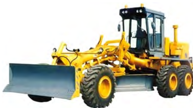
Рис.6. Средний автогрейдер ДЗ-180А
