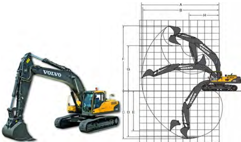
Рис.3. Технические характеристики экскаватора Volvo EC-290В
