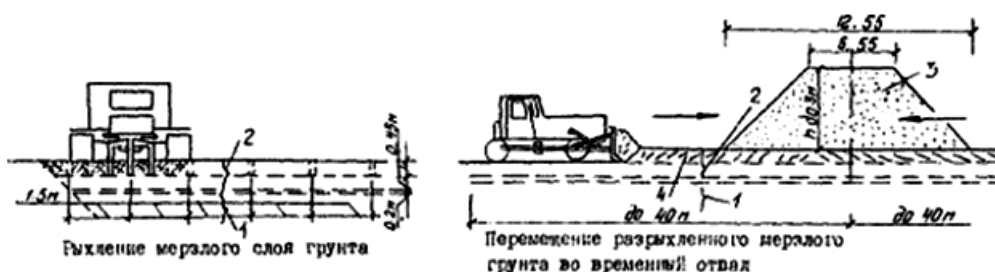
Рис.10. Схема производства работ при рыхлении грунта
