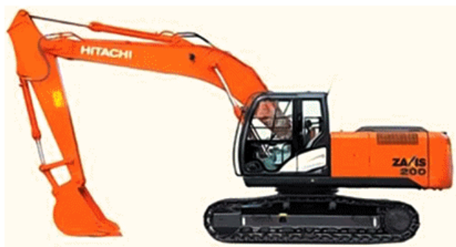
Рис.2.* Одноковшовый, гидравлический экскаватор Hitachi ZX200-3
