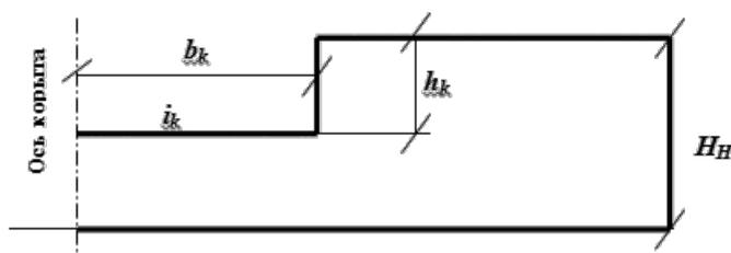
Рис.7. Схема определения глубины вырезаемого корыта
