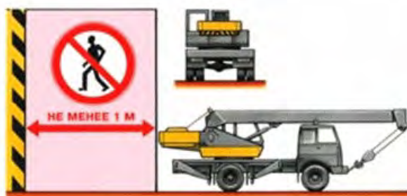
Рис.30. Схема установки крана вблизи препятствий
