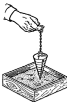
Рис.6. Проверка подвижности раствора эталонным конусом
