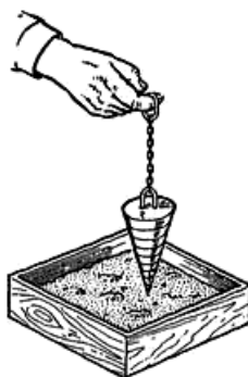
Рис.16. Проверка подвижности раствора эталонным конусом
