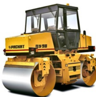
Рис.6. Гладковальцевый каток ДУ-98
