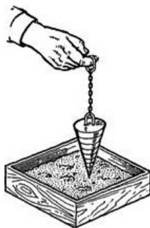
Рис.32. Проверка подвижности раствора эталонным конусом
