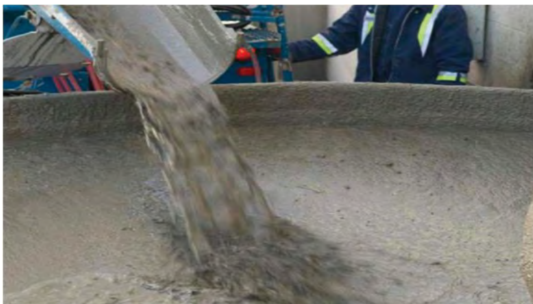
Рис.4. Добавка "Пластификатор С-3" вводится в бетонную смесь в виде водного раствора рабочей концентрации
