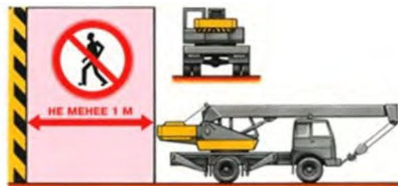
Рис.20. Схема установки крана вблизи препятствий
