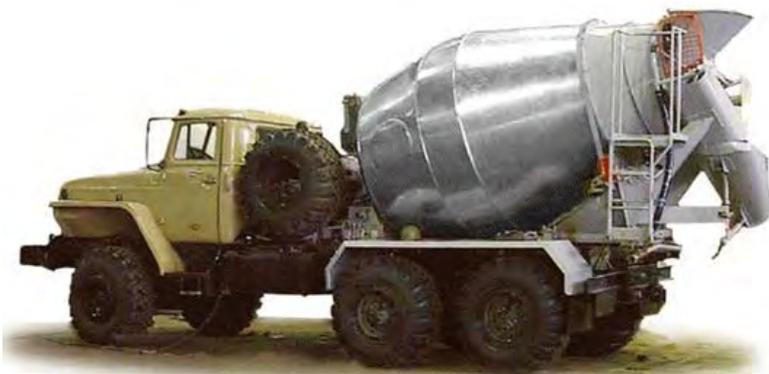
Рис.4. Автобетоносмеситель СБ-159А
