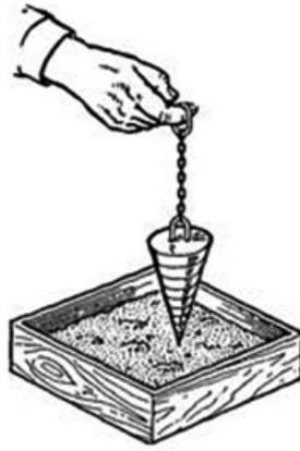
Рис.18. Проверка подвижности бетона эталонным конусом
