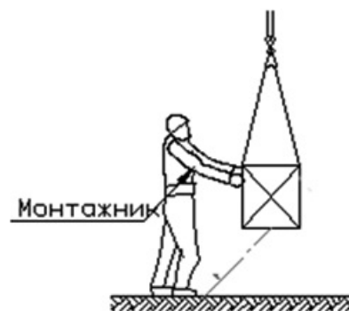
Рис.4. Установка блоков ФБС
