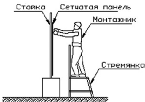
Рис.6. Установка сетчатых панелей
