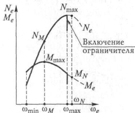
Рис. 2.2. Внешняя скоростная характеристика бензинового двигателя с ограничителем угловой скорости коленчатого вала
