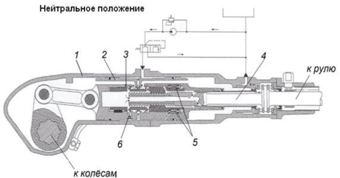
Рис. 5.21. Нейтральное положение привода рулевого управления Фирмы «Цанрадфабрик (Zahnradfabrik)»:
