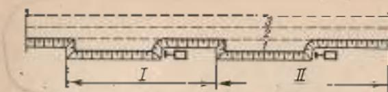
Рис. 14. Деление уступа на заложки и блоки
