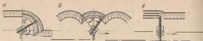
Рис. 11.17. Виды забоев роторных экскаваторов
