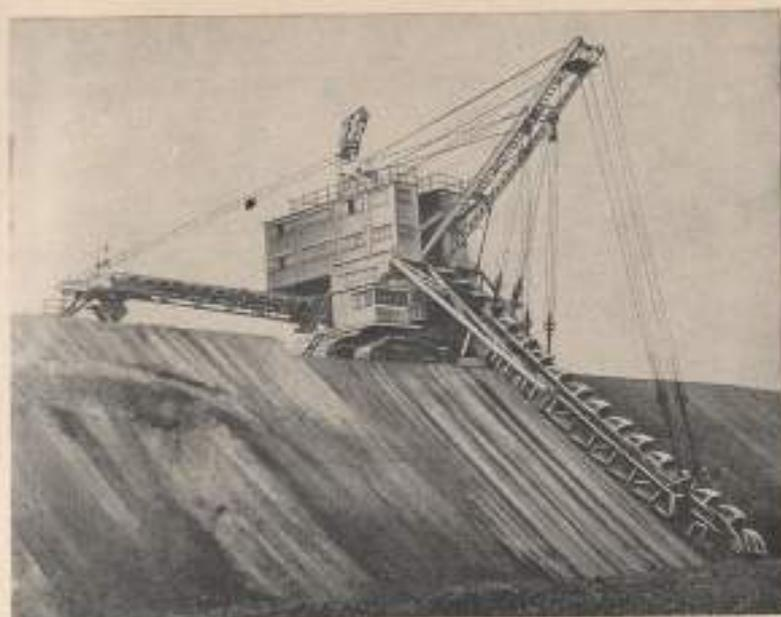
Рис. III.12. Многоковшовый цепной экскаватор нижнего черпания
