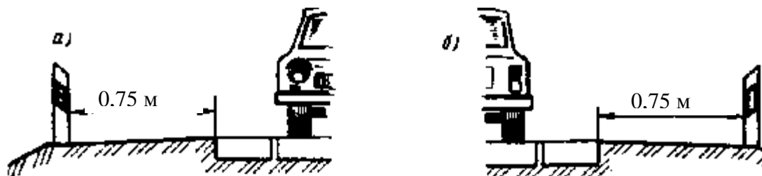
Рис. 6.1. Схема размещения направляющих столбиков на дороге с левой (а) и правой (б) сторон
