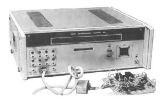
Рисунок 7.38 — Внешний вид тестера внутрисхемного контроля
