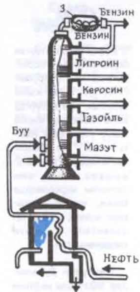
21-сурет. Түтүктүү меш жана ректификациялык колонна.
